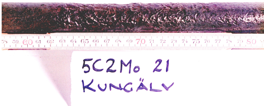
Figur 6.5. Rör av låglegerat stål SS 2225 (rör 21) från Åkerhög nära Kungälv. Extra belyst.
