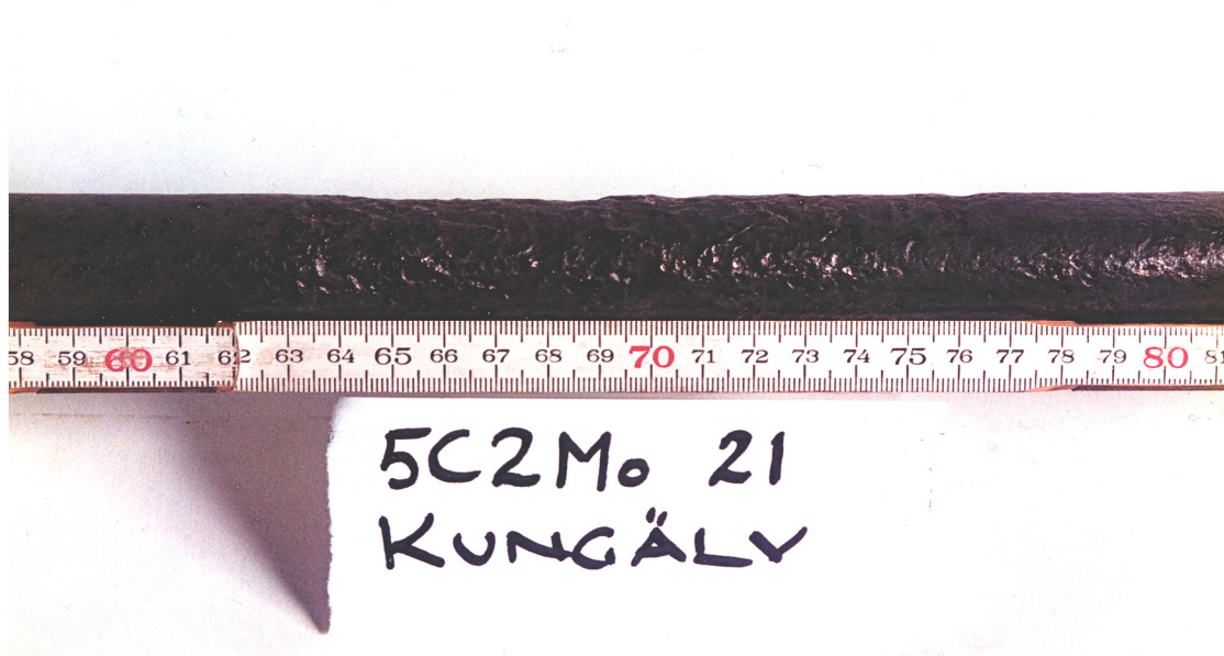
Figur 6.4. Rör av låglegerat stål SS 2225 (rör 21) från Åkerhög nära Kungälv.
